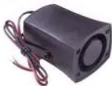
La sirena è alimentata dalla linea a 12V, e comandata tramite relè da una porta digitale della Piattaforma Arduino, con livello sonoro di 105dBA, e a una frequenza di 1.5kHz, con dimensioni 51 x 51 x 35 mm. Il relè è installato sulla proto-shield aggiuntiva descritta alla sezione 3.2.1.2.3.
