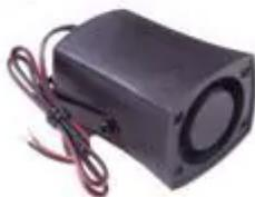
La sirena è alimentata dalla linea a 12V, e comandata tramite relè da una porta digitale della Piattaforma Arduino, con livello sonoro di 105dBA, e a una frequenza di 1.5kHz, con dimensioni 51 x 51 x 35 mm. Il relè è installato sulla proto-shield aggiuntiva descritta alla sezione 3.2.2.3.4.
